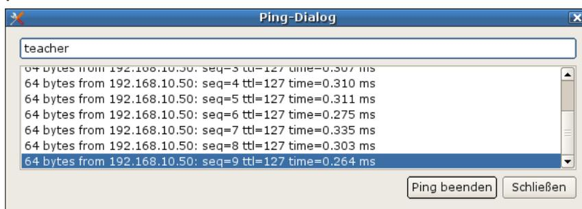
*Der Client stellt eine Verbindung zum Server her und im unteren Bereich des Fensters wird der Ping-Befehl solange ausgeführt, bis Sie ihn beenden.*
